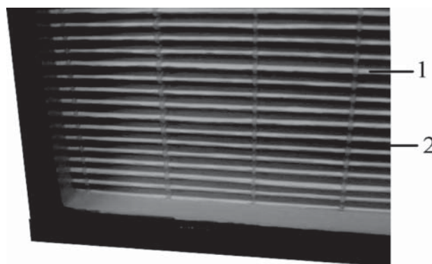
Рис.2 Фрагмент фильтра с нитевыми сепараторами; 1 – фильтрующий материал;
